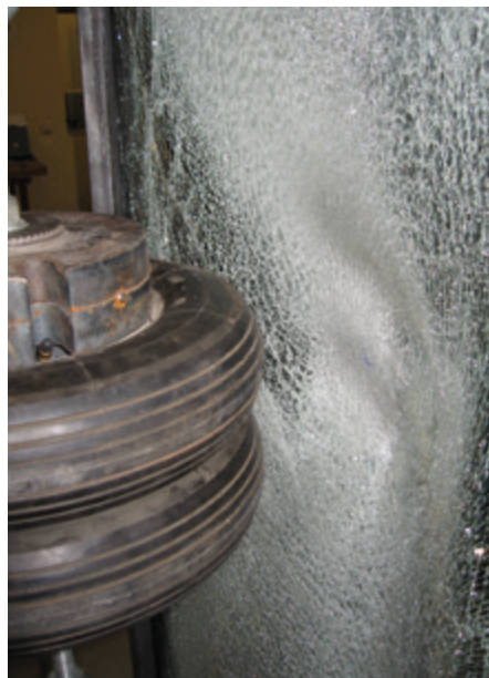
Nach normgemäßem Nachpendeln aus 100 mm Höhe
