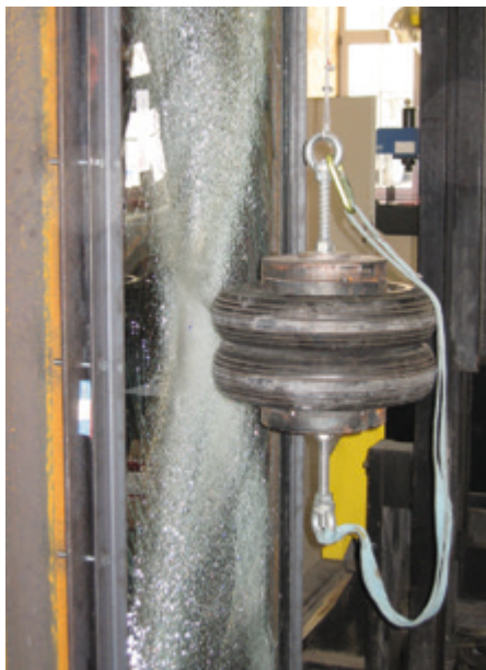
Nach Normprüfung bis 1200 mm Fallhöhe
