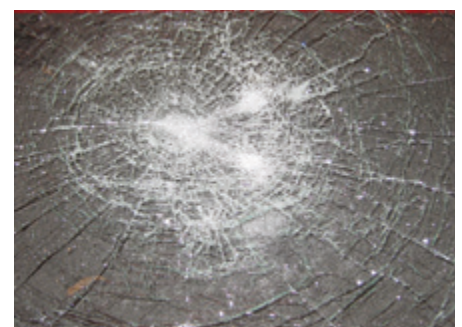
Prüfung bestanden - kein Durchschlag
